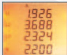
Display LCD retroiluminado de 4 líneas (una de ellas para visualización de energías)
